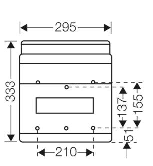
8xø7-12 mm 8xø7-14 mm 4xø12-20 mm 1xø16,5-29 mm 8xø7-12 mm 8xø7-14 mm 4xø12-20 mm 1xø16,5-29 mm
